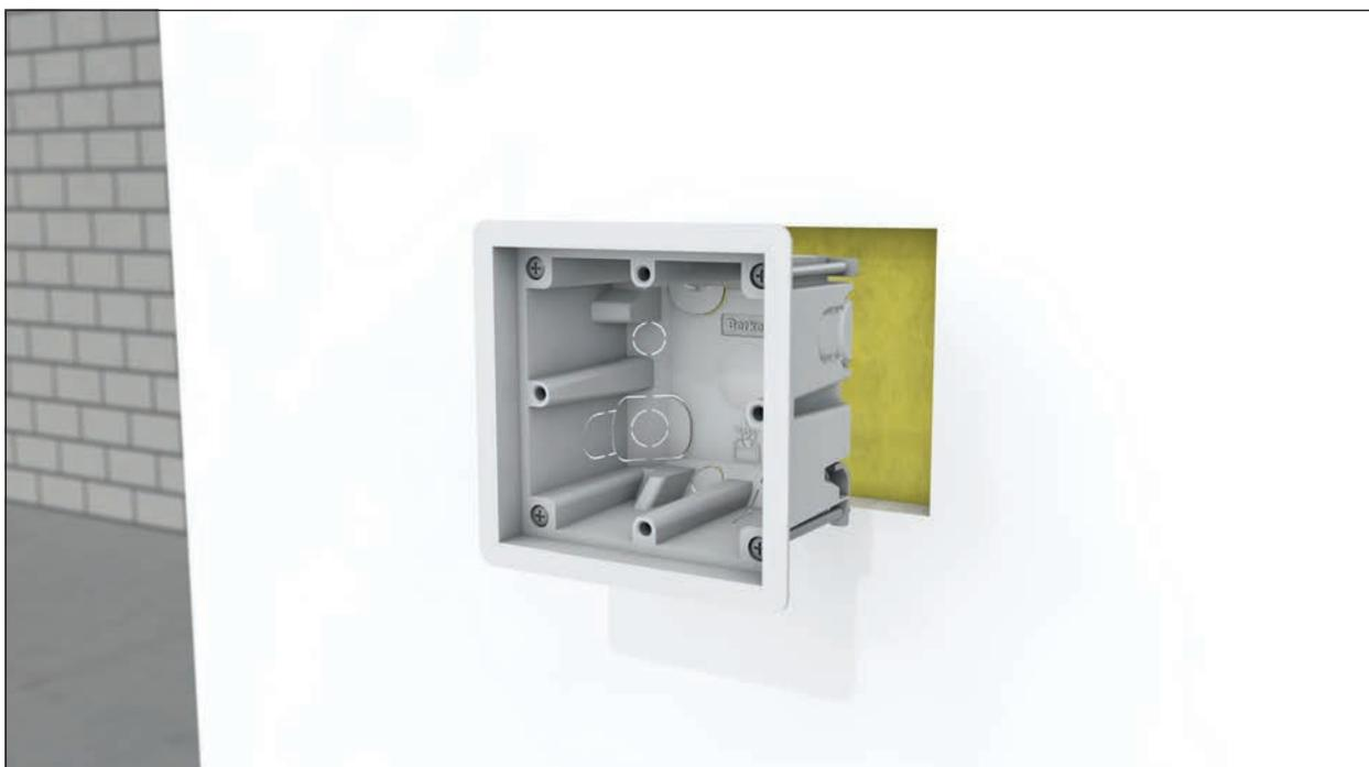
Bild 5: Eine hellgraue R.8 Hohlraumdose wird in die Öffnung eingesetzt.
