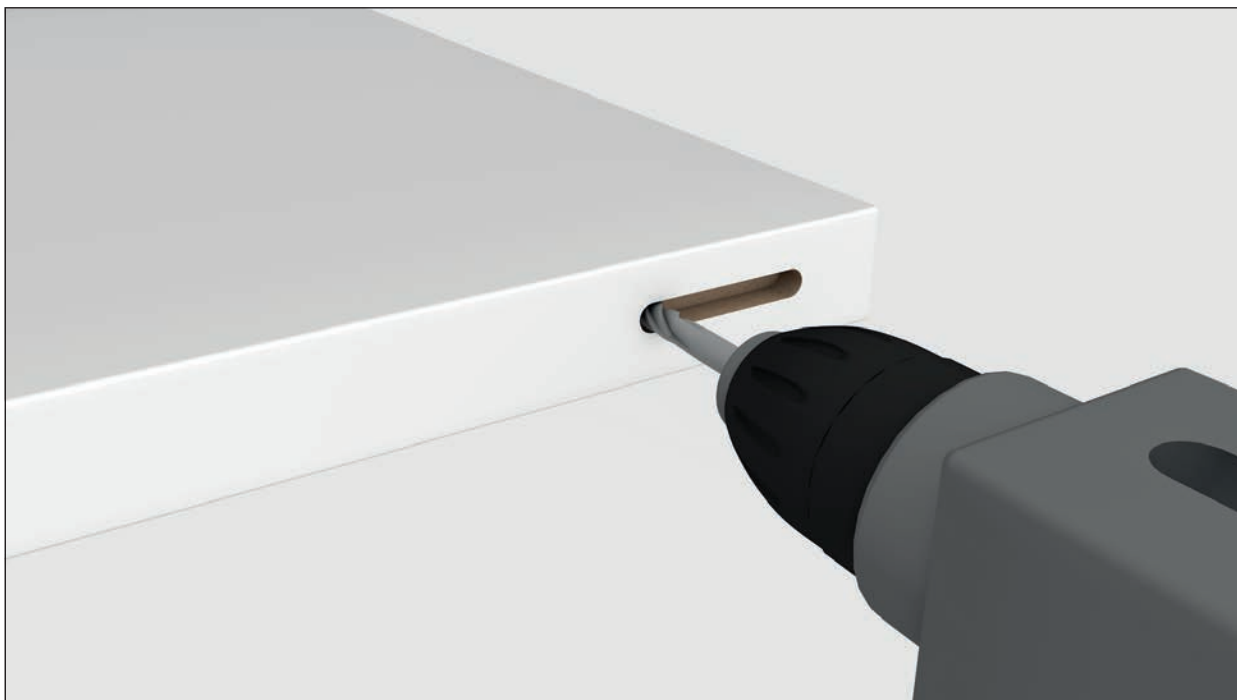
Bild 26: Mit einer Industriefräse wird stirnseitig eine erste Nut gefräst.
