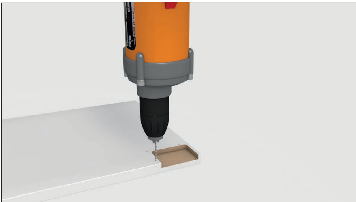
Bild 33: Mit einer Bohrmaschine werden 3 Zentrierlöcher gekörnt.
