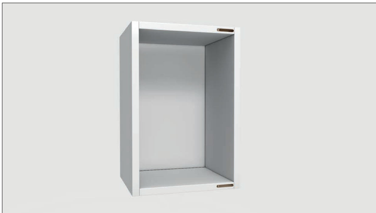
Bild 29: Der komplette Korpus wird im zusammengebautem Zustand gezeigt. Oben und unten sind jeweils die Fräsungen zu sehen.
