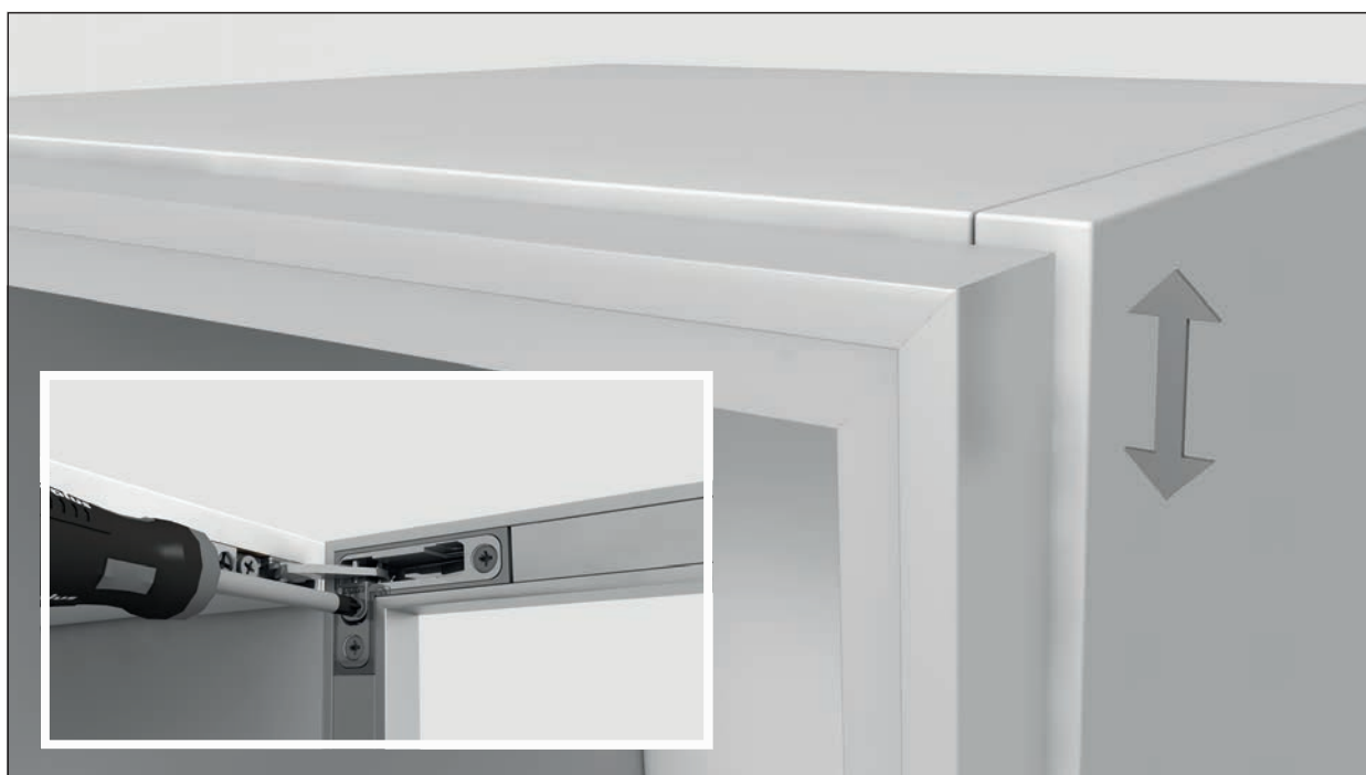
Bild 39: Mit einem Schraubenzieher wird die rechte Schraube nacheinander in beide Richtungen gedreht. Der Türflügel bewegt sich nach oben und unten.
