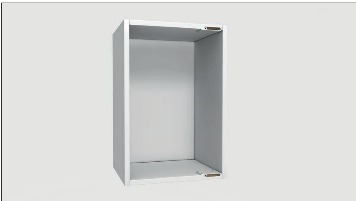
Bild 35: Der komplette Korpus wird im zusammengebautem Zustand gezeigt. Oben und unten sind jeweils die Adapterplatten zu sehen.
