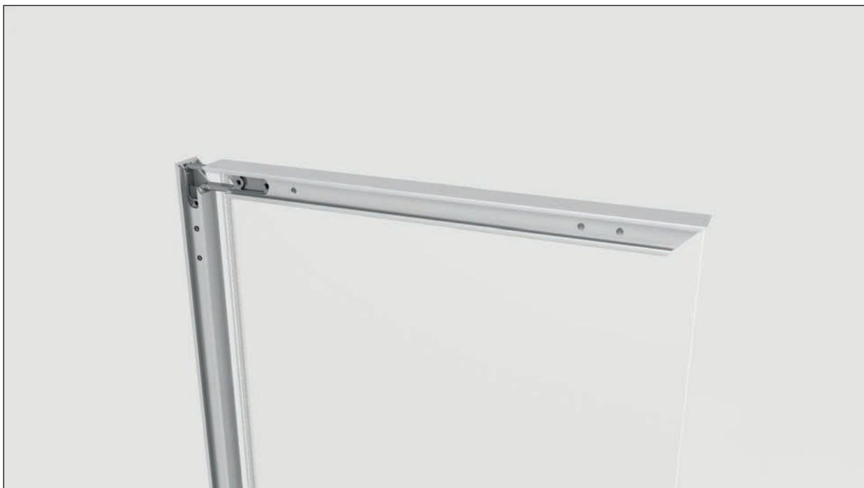
Bild 10: Das linke Rahmenprofil mit dem zuvor eingeschobenen Rahmenverbinder wird von links auf die Glasscheibe geschoben. Zuerst wird wieder das Einfassprofil aufgesteckt.
