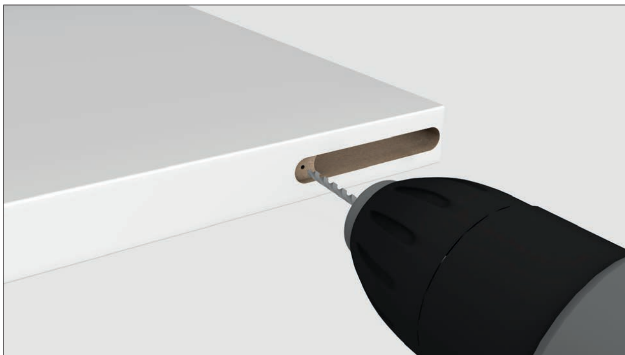
Bild 28: Mit einer Bohrmaschine wird ein Zentrierloch gekörnt.
