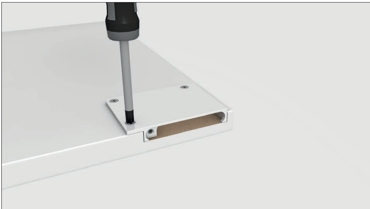
Bild 34: Eine Adapterplatte wird in die Fräsung gefügt und mit 3 Schrauben befestigt.
