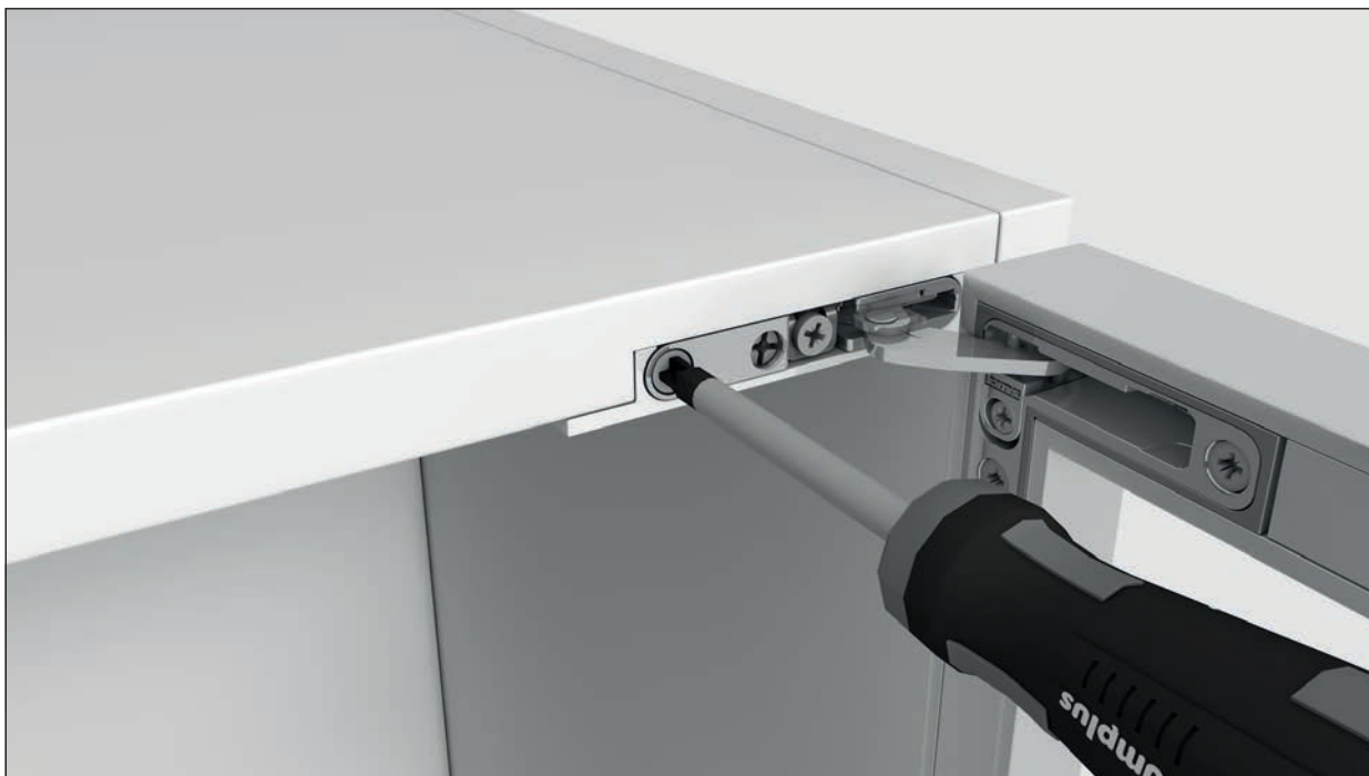
Bild 36: Das Türband wird in die Adapterplatte eingefügt und mit einer Schraube befestigt.
