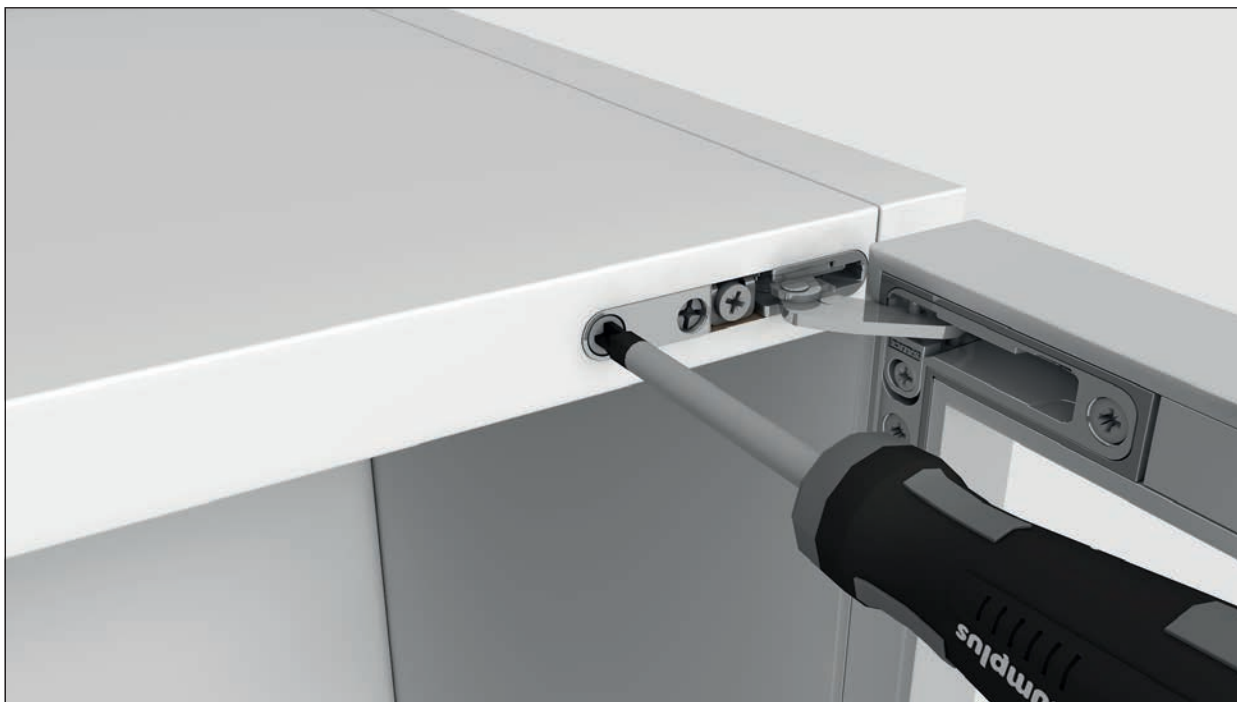
Bild 30: Türband wird in die Fräsung stirnseitig eingeschoben und festgeschraubt.
