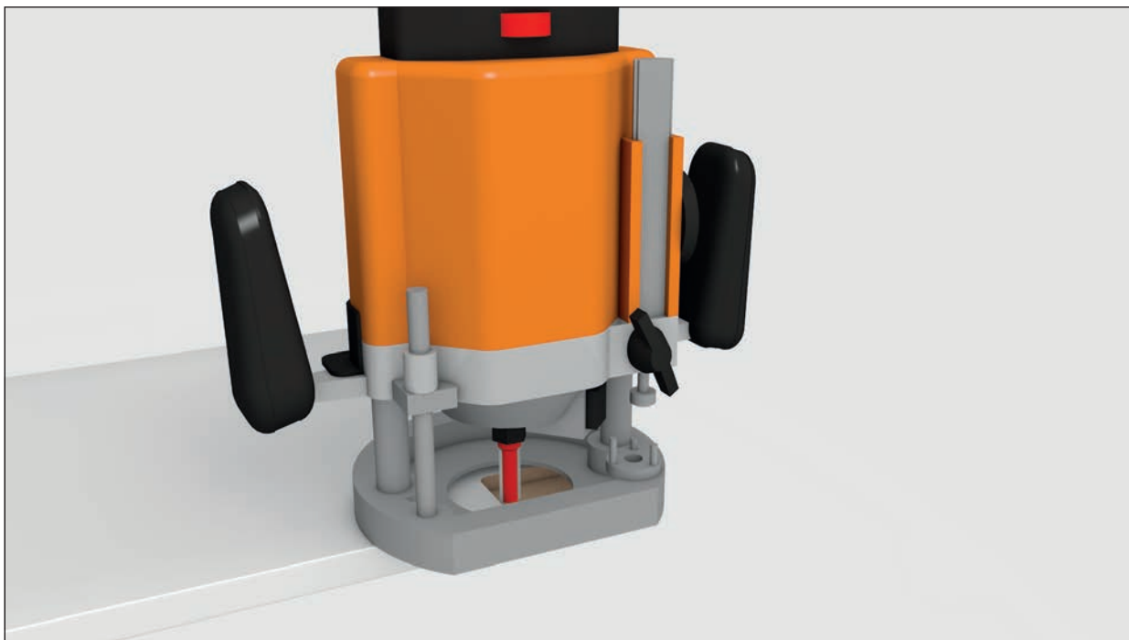
Bild 32: Mit einer handelsüblichen Oberfräse wird von oben eine Fräsung eingebracht. Dies verdeutlicht gegenüber der zuvor gezeigten Industriefräse, dass diese Variante auch vor Ort hergestellt werden kann.
