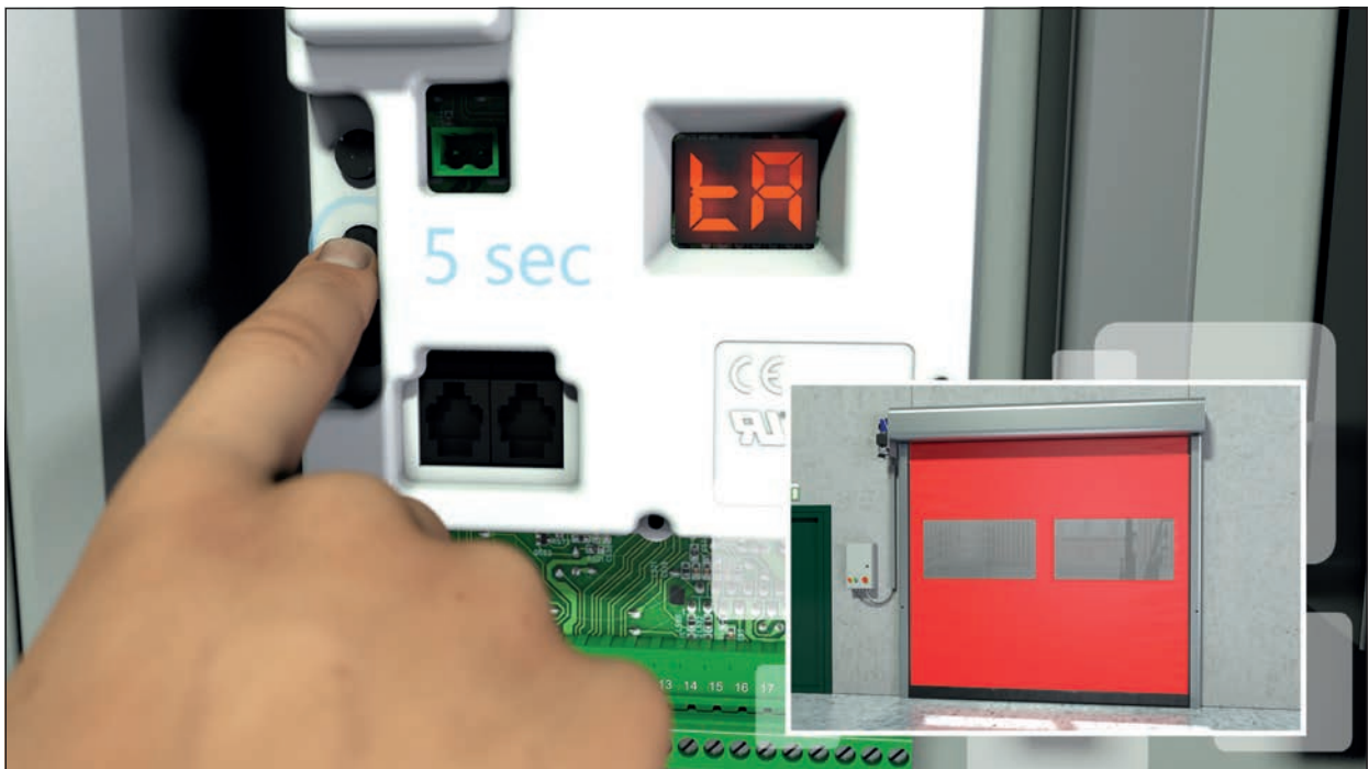
Bild 27 - Finger drückt auf mittlere Taste P2 für 5 Sec bis LD1 blinkt, im Display wird „tA“ angezeigt.
