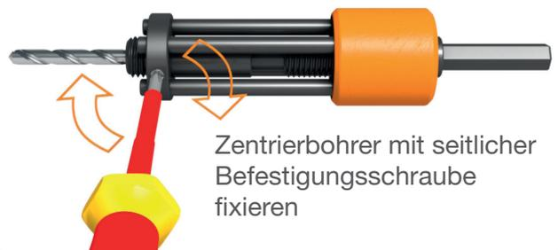
Zentrierbohrer mit seitlicher Befestigungsschraube fixieren
