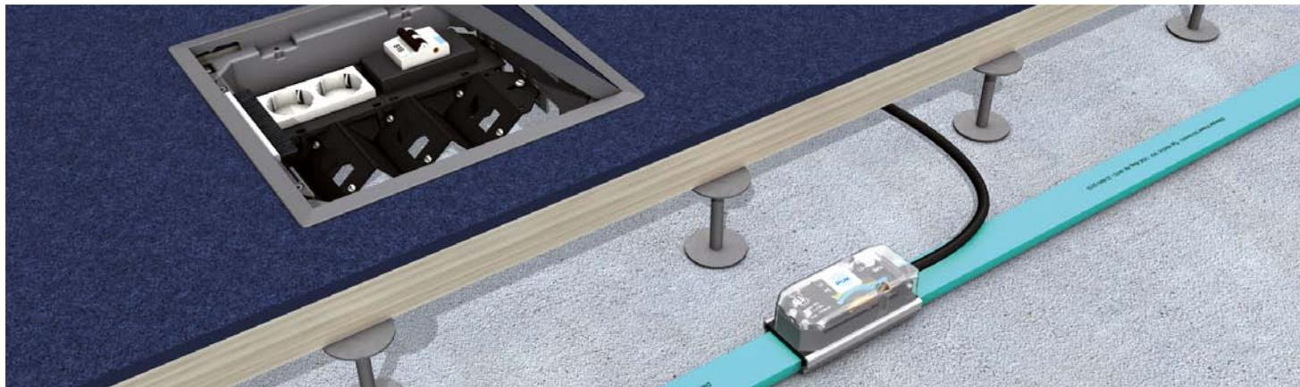
Vorkonfigurierte Gerätebecher komplett mit Snap-In Gerätebuchse, vorverdrahteten Steckdosen, Flachleitungsadapter angeschlossen an eine 2 m/3 m Anschlussleitung (3 x 4 mm<sup>2</sup>) und FI/LS-Schalter 16 A. Inklusive aller Abdeckungen und Montagematerialien. Zum Einrasten in eine runde oder eckige Einbaueinheit. Zum direkten Anschluss an 5 x 10 mm<sup>2</sup> Flachleitungen, Vorsicherung bis 50 A.
