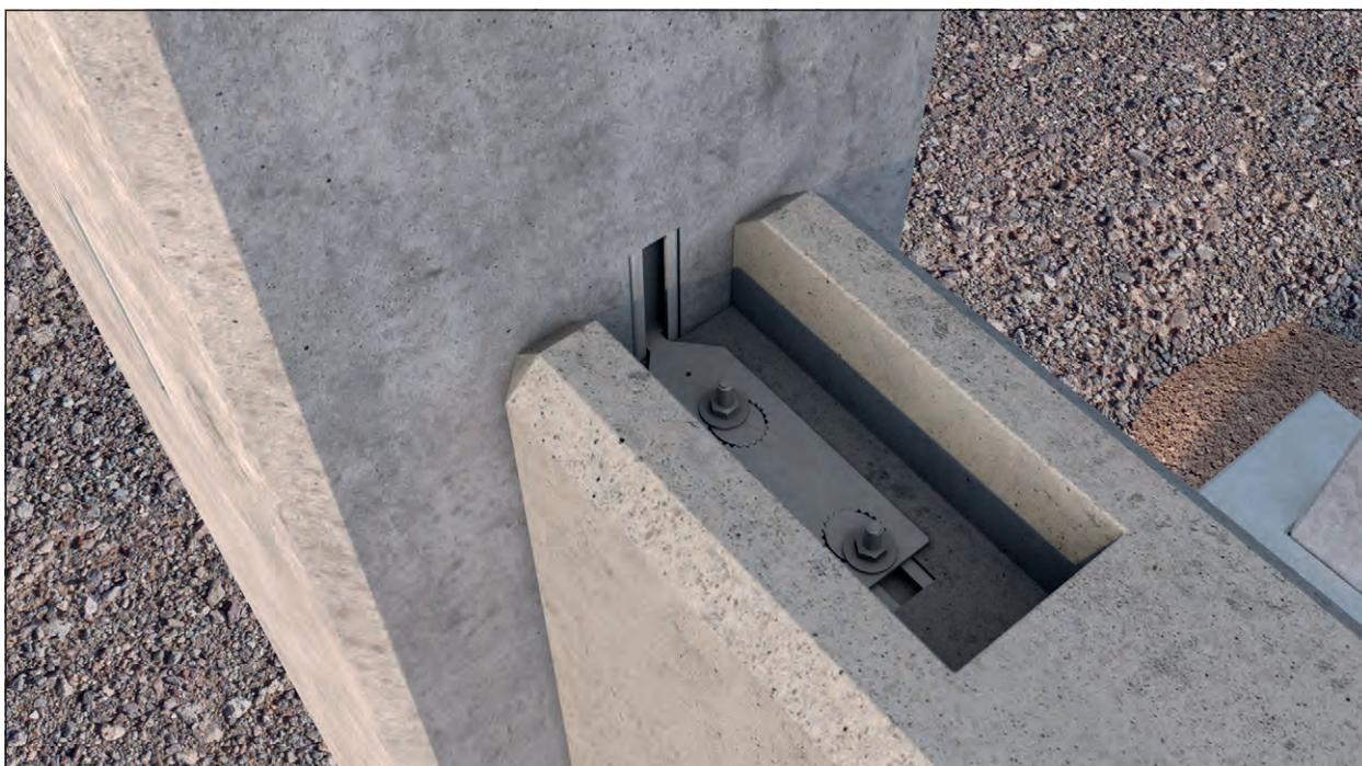
Bild 7: Verbindertasche ist befestigt. Anschließend können Details gezeigt werden, wie z.B. das Justieren der Wände durch verdrehen der Zentrierelemente in der Verbindertasche.
