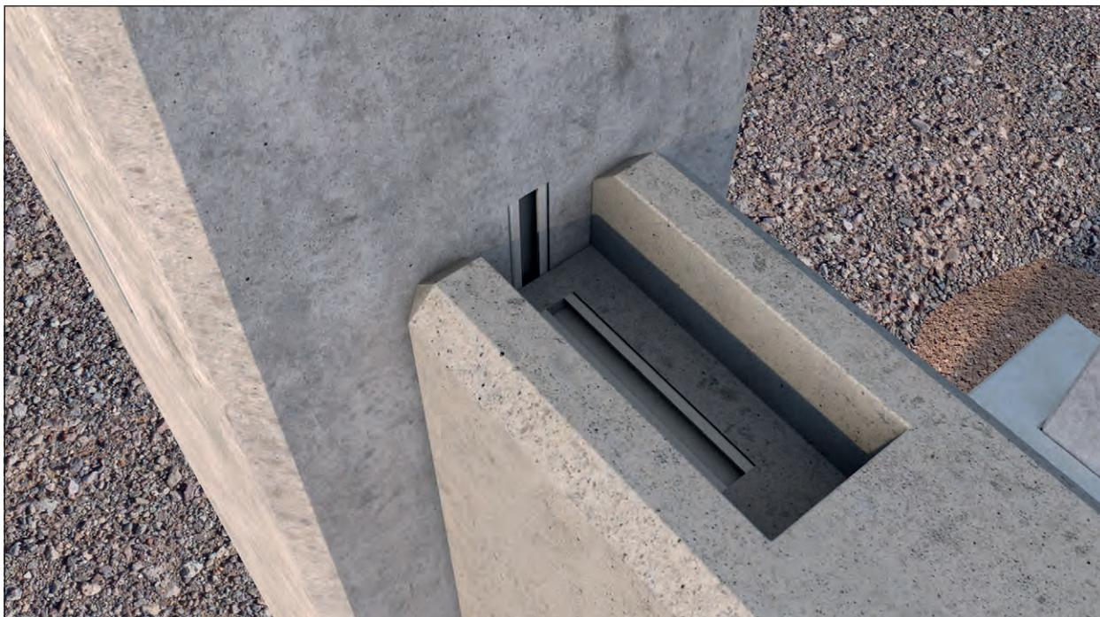
Bild 4: Detailansicht auf die Verbindung zwischen Wand und Stütze. Die beiden einbetonierten Ankerschienen sind zu sehen.
