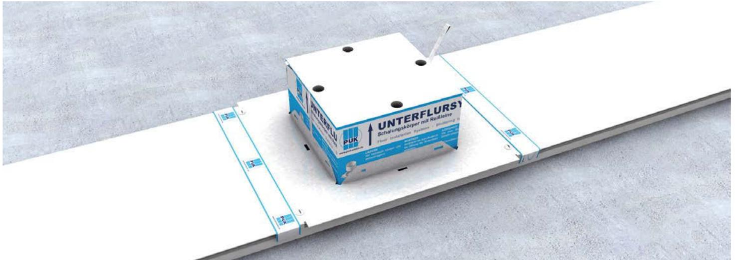
Offener zwei- bzw. dreizügiger Kabelkanal UKR in den Nennbreiten  $B = 300, 400$  und  $500$  mm aus Stahlblech mit einer Länge  $L$  von  $3000$  mm. In den Höhen  $35, 60, 85$  und  $110$  mm. Belastbar mit bis zu  $0,75$  kN. Bestehend aus einem Unterteil mit Trennsteg und separatem Oberteil.
