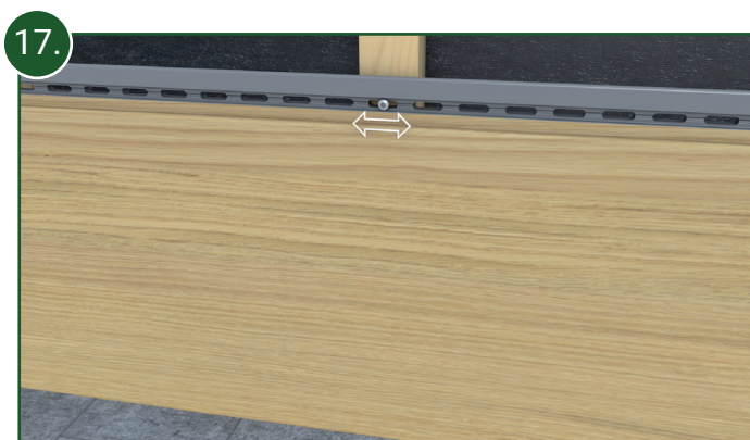
17. Die Verschraubung der Fassadenprofile mit der Traglattung erfolgt mittig durch die in den Federbereichen eingebrachten Langlöcher mittels der Fassadenschrauben.
